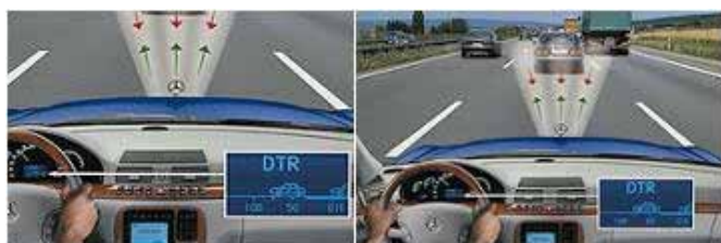
Obr. 4 Funkce systému Distronic.
