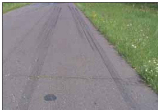
Obr. 12. Stopy po blokování kol získané při brzdění na pláštích s protektorem vyrobeným ze směsi Kabat s odpojeným systémem ABS.
