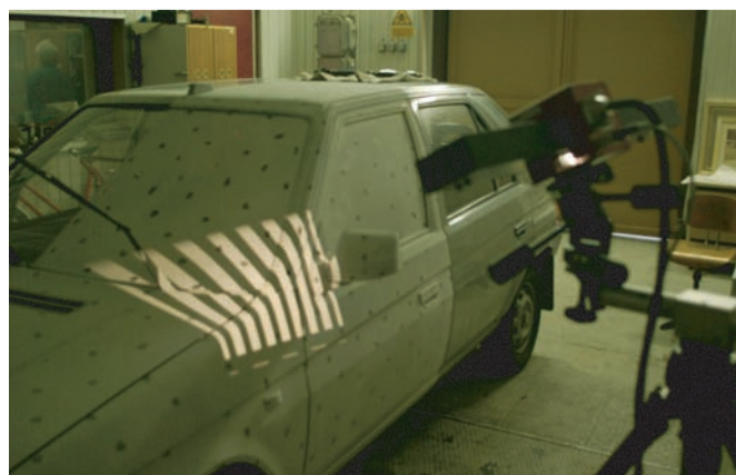
Obr. 7 Úprava povrchu s RP; projekce světelné mřížky při snímání na vozidlo
