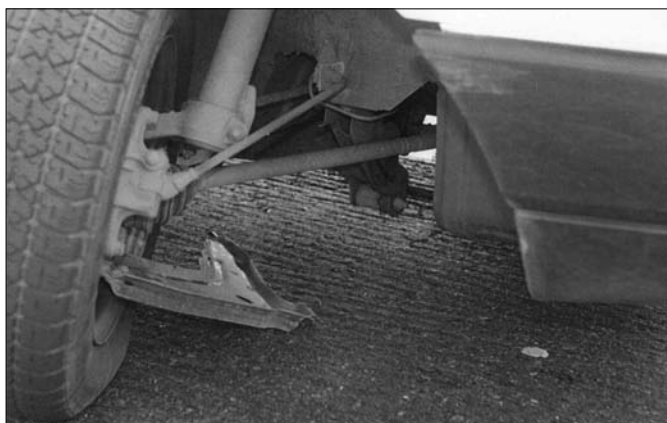
Foto 10 Vyvrácené pravé kolo táhne spojovací tyč řízení vpravo a tím stáčí levé kolo doleva
