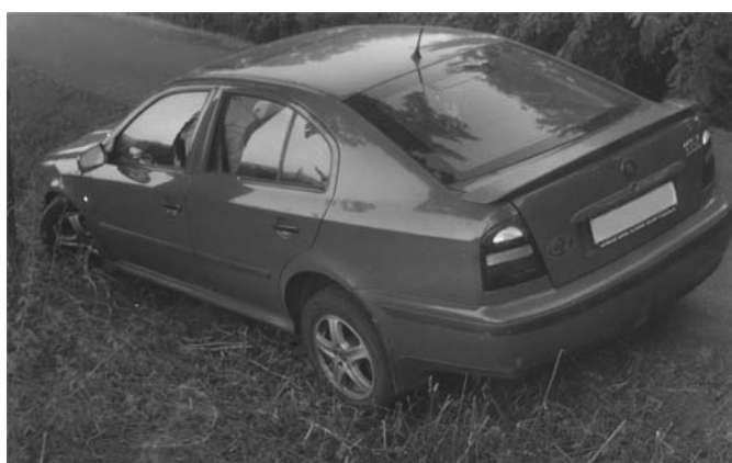
Foto 2 ŠKODA Octavia, levé kolo vytočeno doleva tahem spojovací tyče řízení
