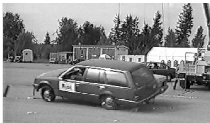
Foto 7 Crash-test: tečná kolize s druhým automobilem (zdvih boku)
