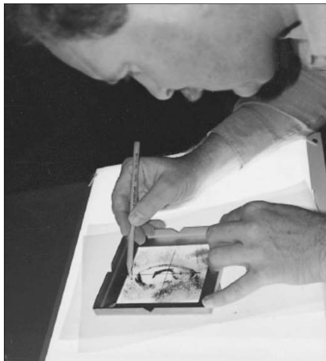
Obr. 14 Vytvoření srovnávací šablony pomocí ocelového rámečku.
