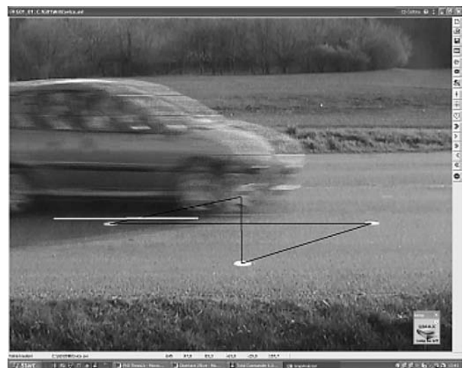
Obr. 10 Odměření délky pohybu bodu dotyku předního kola s vozovkou
