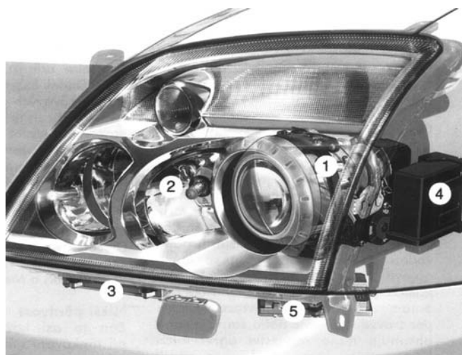
Obr. 20 Adaptivní bi-xenonové světlometry Hella dodávané do vozu Opel Vectra a Signum, jsou jako první vybavené aktivně natáčecím modulem i pasivním světlometem pro osvětlení křižovatek: 1 – natáčecí bi-xenonový modul, 2 – reflektor postranního světlometu, 3 – jednotka elektrického napájení, 4 – řídicí jednotka nastavení světlometů, 5 – předradník xenonových světlometů
