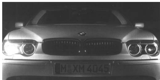
Obr. 22 Porovnání stupně oslnění u dnes již běžného bi-xenonového světlometu (vlevo) a vyvíjeného pixelového světlometu (vpravo)
