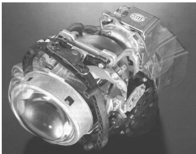
Obr. 18 Projektor natáčecího modulu Hella je uložen do rámu, otočného kolem svislé osy v rozsahu \pm 15^\circ , což stačí pro osvětlení zatáček do poloměru asi 200 m; pro velmi táhlé nebo naopak ostré zatáčky lze přidat statický postranní světlomet, jaký má Audi A8
