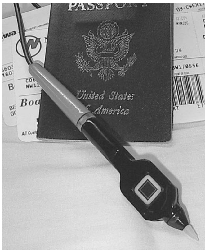
Obr. 16 Pero Pen-One je prvním psacím perem s integrovaným snímačem otisku prstu- Otisk je snímán 0,25" palcovým čtvercovým senzorem firmy AuthenTec.
