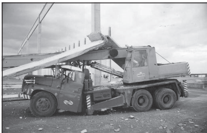
Obr. 4 Zničený autojeřáb, v kterém při havárii haly seděl jeho řidič, jehož nepříjemné pocity si snad ani nelze představit.
