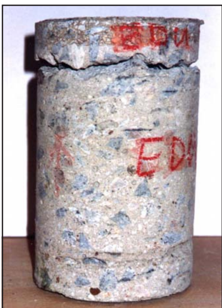
Obr. 4 Mrazové narušení betonu.
