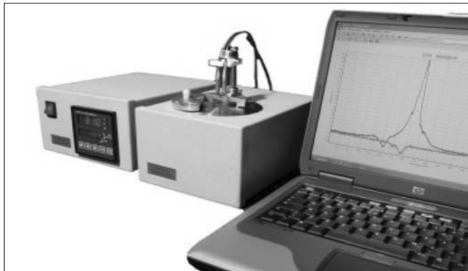
Obr. 7 Měřicí zařízení diferenční termické analýzy DTA 551 Ex
