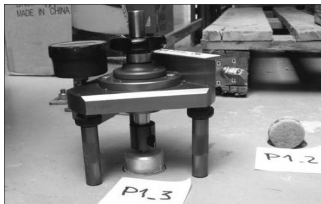
Obr. 5 Zkouška přídržnosti pomocí odtrhoměru DYNA Z6
